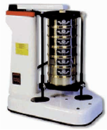
Obr. 2 – Přístroj na separaci zrna siláže (Rotap)
