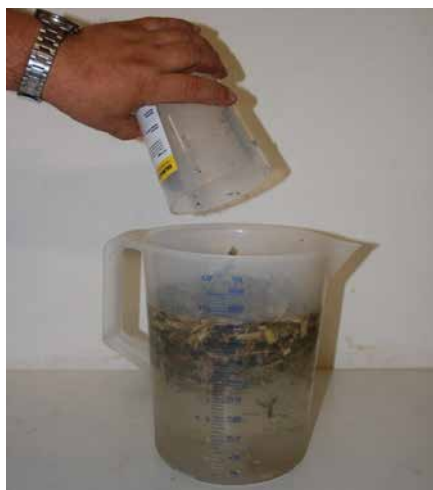
Obr. 4 – Mokrá separace vzorku kukuřičné siláže
