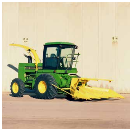
Model 5830, první řezačka John Deere se zrnovým procesorem
