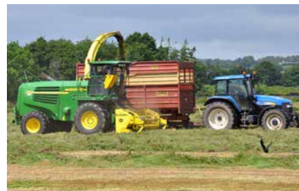
Řada 7000 – první řezačka s plynulým nastavením délky řezanky
