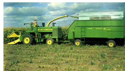
V USA nebyly výjimkou samojízdné sklízecí řezačky bez kabiny, na fotografii model 5200
