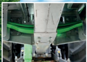
Oje odpruženo příčnými listovými pery
