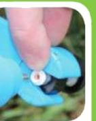
En el TSU usado se ve un émbolo rojo indicando que el tubo contiene una muestra y no puede ser usado de nuevo.
